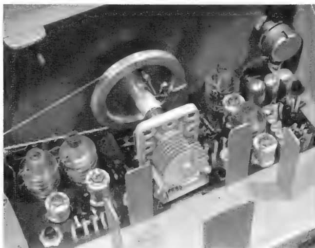
Bild 5. Teilansicht von rückwärts: links der Hf-Teil, in der Mitte der Banddrhokondensator und rechts der Audienteil
