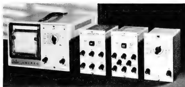
Tragbarer Universalschreiber Unireg von Siemens mit Mikroampereinschub. Daneben drei weitere Meßbereicheinschübe
